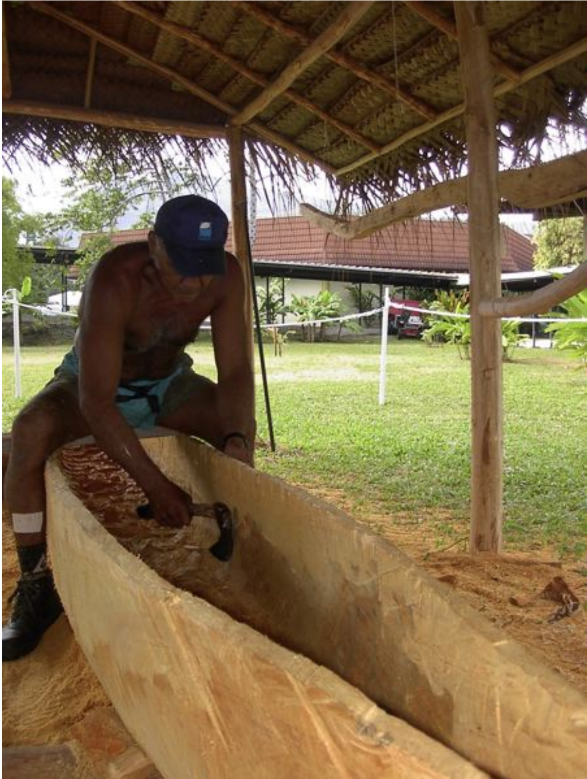
le travail d'évidage de la coque à l'aide du tupa , hache dotée d'une lame courbée
